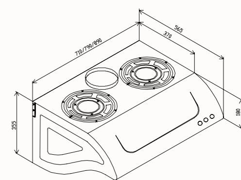
1.吊鐵螺絲中心尺寸686/766/866mm
