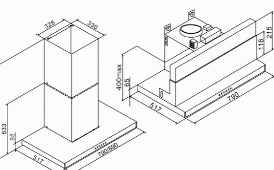
1. 機身底部至掛勾螺絲鑽孔高度359mm
