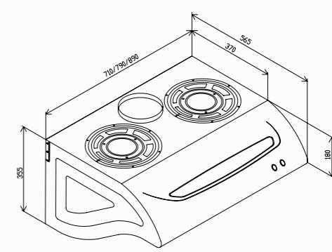
1.吊鐵螺絲中心尺寸686/766/866mm
