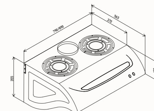
1.吊鐵螺絲中心尺寸766/866mm
