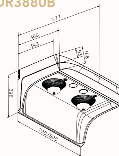
1.吊鐵螺絲中心尺寸706/806mm
