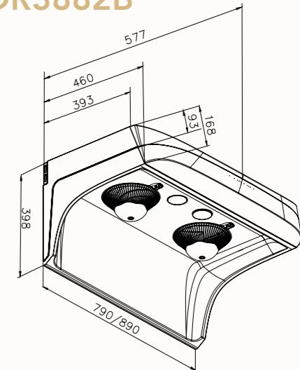
1.吊鐵螺絲中心尺寸706/806mm
