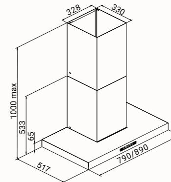
1. 機身底部至掛勾螺絲鑽孔高度359mm
