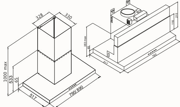
1. 機身底部至掛勾螺絲鑽孔高度359mm
